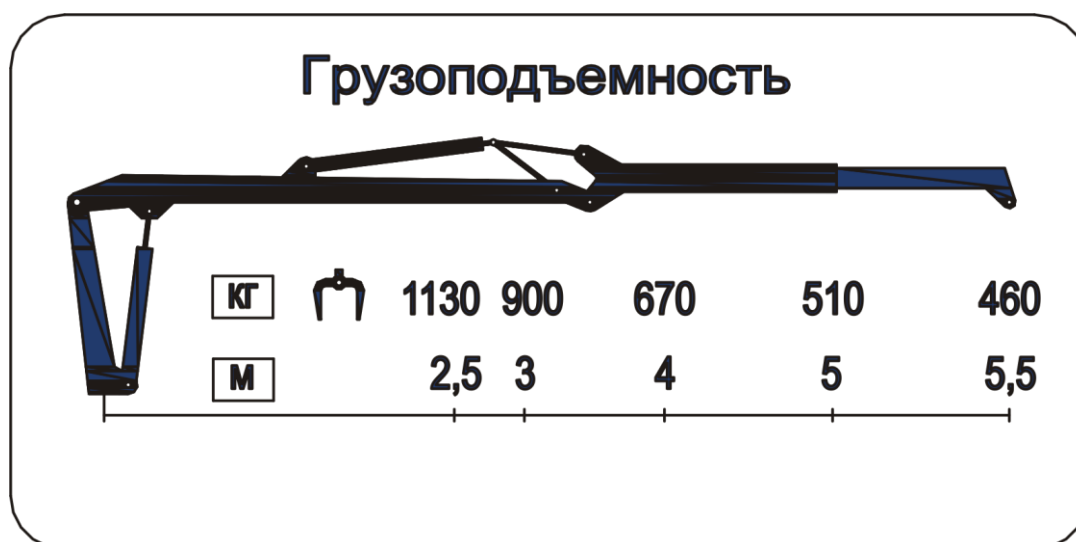
Рисунок 6.3 – Табличка грузоподъемности гидроманипулятора ГМ-42
