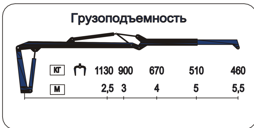
Рисунок 1.11 – Табличка грузоподъемности гидроманипулятора ГМ-42
